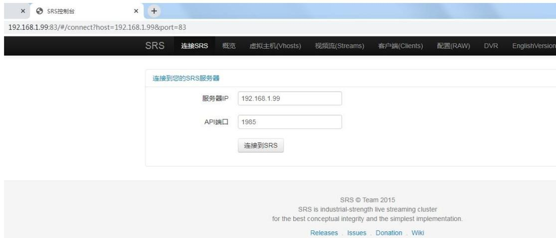
API 端口 1985，登陆连接到 SRS，概况显示 SRS 服务器 CPU 和内存等情况，虚拟主机显示 SRS 直播服务器共有多少视频流，视频流显示详细视频流信息，可以使用 VLC 工具进行 RTMP 播放。
